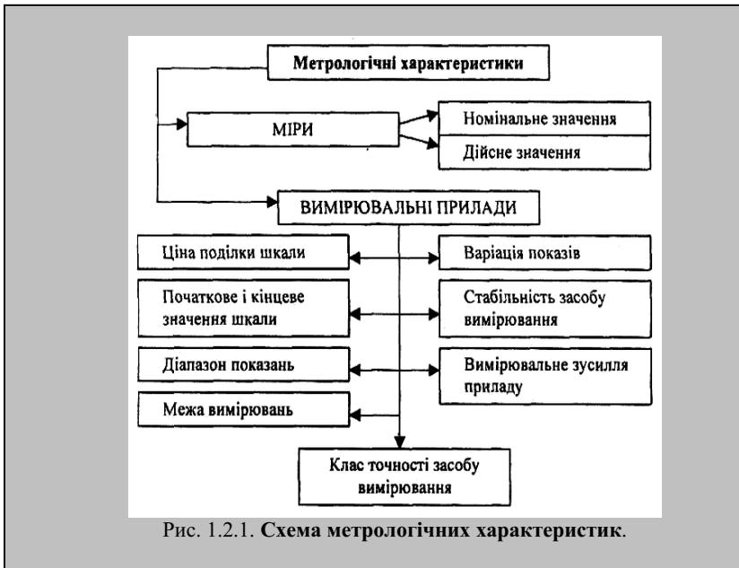
Рис. 1.2.1. Схема метрологічних характеристик.
